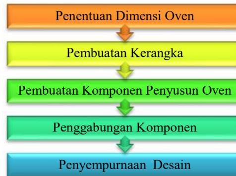
**Gambar 2.** Diagram alir pembuatan desain.
